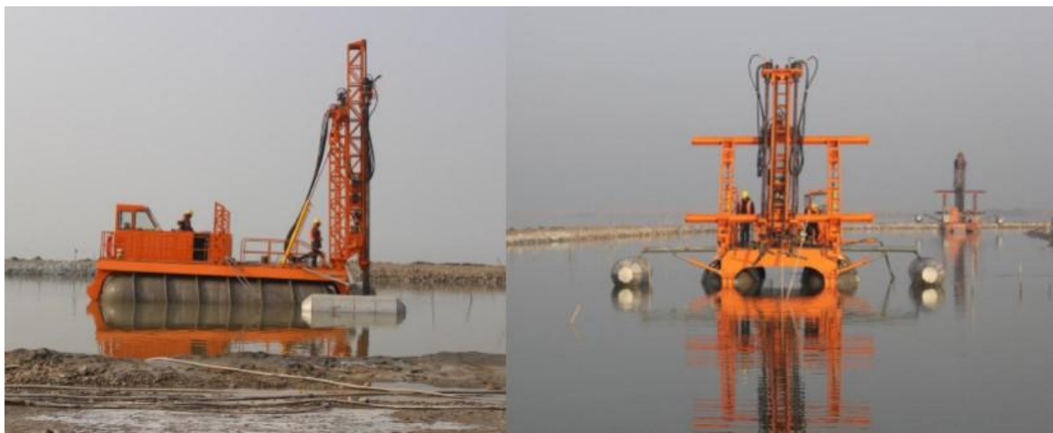
图 3.2-1 可在浆涂面上行走的淤泥固化桩施工设备
