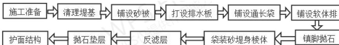
图 3.4-1 工程施工总流程图
